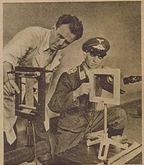
In unserem Bilde links oben und im Bild oben sieht man Apparate für ballistische Messungen, die vor der Mündung eines Flakgeschützes aufgebaut sind. Die hier vorgenommenen Versuche dienen in gleicher Weise der Weiterentwicklung der Flugzeugbewaffnung wie der Flugzeugabwehr
