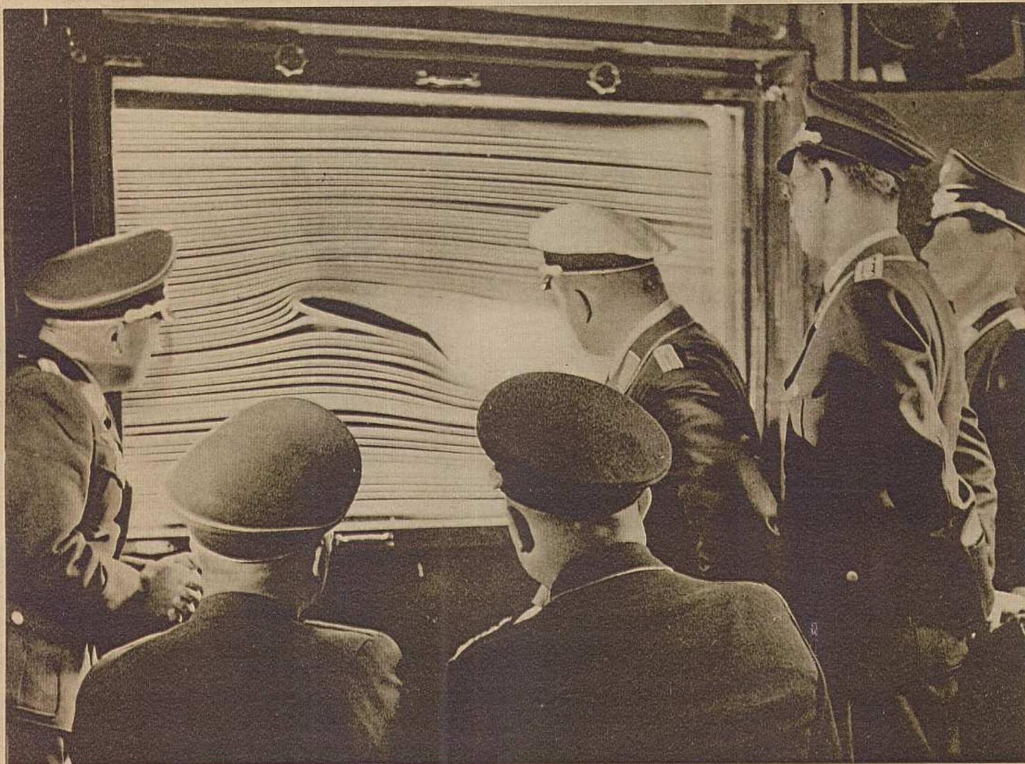
Besonders wichtig für die Leistungsfähigkeit und Stabilität des Flugzeuges ist auch die Konstruktion der Tragflächen. Auch auf diesem Gebiete werden in der Akademie laufend Versuche durchgeführt, die der weiteren Vervollkommnung der Tragflächen dienen. Im Bilde sieht man das Profil eines Tragflügels im Rauchwindkanal. Man kann hier an den vorbeiströmenden Rauchfäden deutlich die Strömungsverhältnisse studieren und so die günstigste Form jedes einzelnen Teiles des Tragflügels herausfinden
