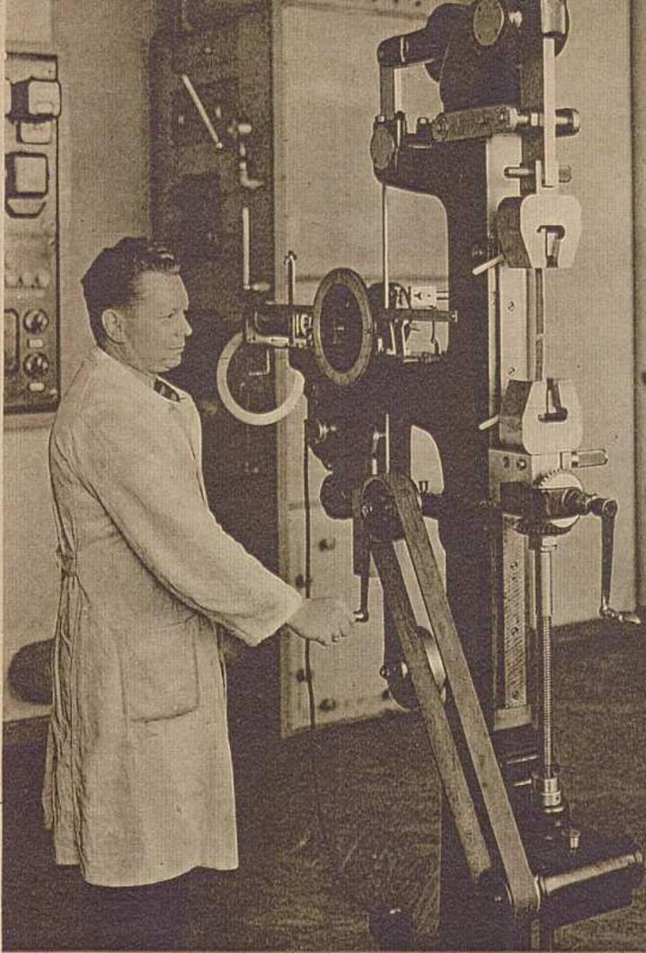
**A**uf diesem Prüfstand (links) wird die Widerstandsfestigkeit des Holzes bei Zugbeanspruchung gemessen, da man auf diese Weise feststellen kann, ob und welche Holzarten für gewisse Flugzeugteile verwendbar sind
