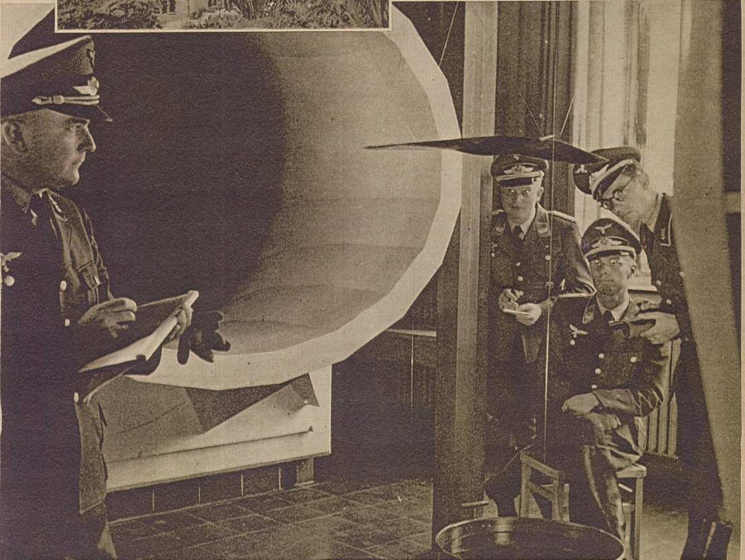
In den Laboratorien und Versuchsräumen der Kriegsakademie der Deutschen Luftwaffe wird wertvolle Arbeit auf dem Gebiete der Forschung und Entwicklung geleistet. Zugleich dienen sie der technischen Weiterbildung der Offiziere, die später für höhere Kommandostellen vorgesehen sind. Unser Bild zeigt Versuche über Strömungsmessungen im Windkanal. Das zu prüfende Modell wird an feinen Drähten aufgehängt, die die Kräfte Wirkung auf genaue Meßapparate übertragen
