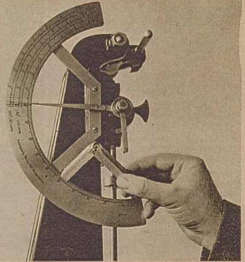
**S**ehr aufschlußreich für die Weiterentwicklung von Baustoffen für die Flugzeugherstellung sind die verschiedenen Werkstoffversuche. Dieses Bild zeigt einen Holzstab, der auf dem Prüfgerät so lange beansprucht wurde, bis er brach
