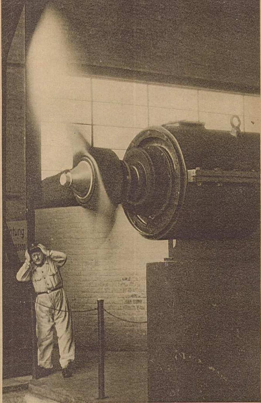
**A**uf dem Luftschaubenprüfstand (oben) werden die Propeller auf „Herz und Nieren“ untersucht. Die dabei entstehende Luftströmung ist so stark, daß der Prüfbeamte sich wenige Sekunden nach Beginn der Prüfung in Sicherheit bringen muß, wenn er nicht mitgerissen werden will
